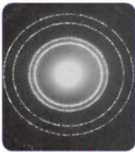
X - ışınlarının alüminyum levhada kırınımı
